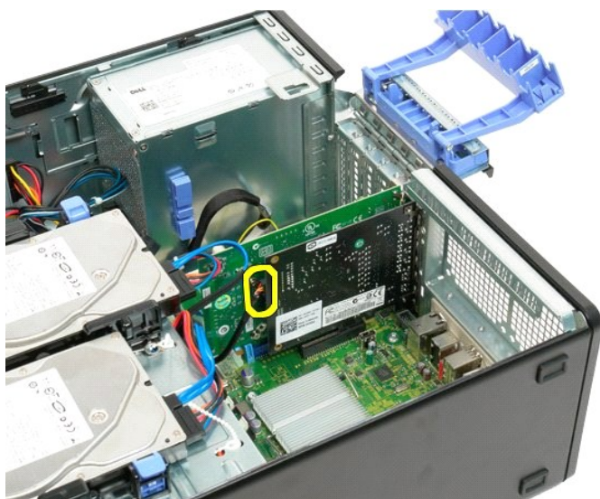
7. Ridicați placa de extensie drept în sus și scoateți-o din calculator.
